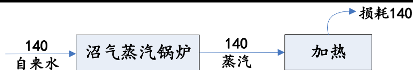
图 2-4 本项目蒸汽物料平衡图（单位：t/a）
